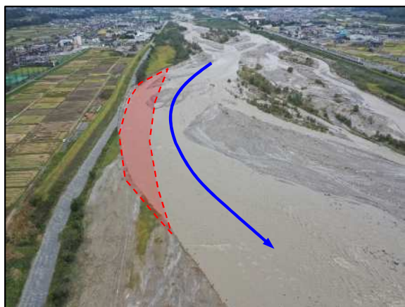
令和元年台風19号の出水の影響により 河岸侵食が発生。 （にらさきしもじょうひがしわり） （韮崎市下條東割地先）
