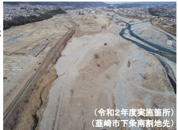
・樹木伐採により、洪水を安全に流下させます。また、河川の状況の把握が容易になります。
