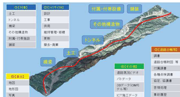
3次元モデルを作成して各種の設計、施工データを格納する一元管理のイメージ
